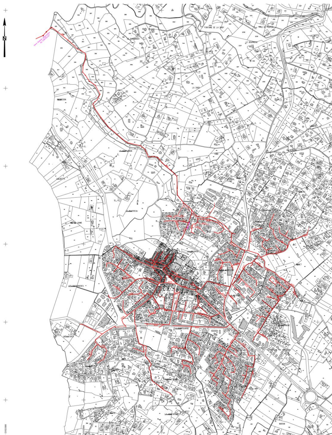
Réseau d'assainissement collectif existant
